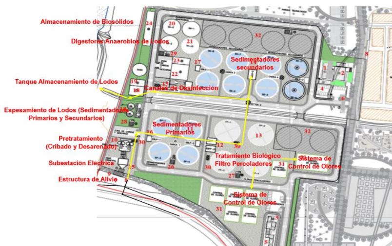
Imagen N° 32. Proceso Tratamiento de Aguas Residuales Domesticas PTAR Neiva
